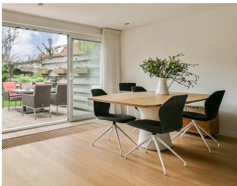
Fraaie aluminium schuifpui, welke naar de linkerzijde en rechterzijde open te schuiven is. Voorgelegen convectorput.
